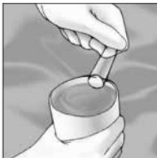
**1.** Sumerja el pequeño tubo en la muestra de agua. Con mucho cuidado, retire el tubo de la muestra de agua, manteniendo el tubo lleno hasta el tope.
