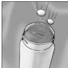
**2.** Deje caer dentro del tubo, dos tabletas para oxígeno disuelto (Dissolved Oxygen TestTabs®). Esto provocará que se derrame un poco de agua.
